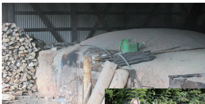
(上) 製炭窯。生出地区の窯は、地元の赤土を利用し、天井が低く、ドーム型になっている。製炭には約10日を要する。
