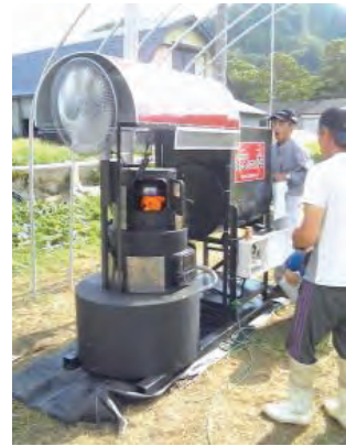
図 2-7 ハウス用もみ殻暖房機 暖房面積：300～400 坪 発生熱量：63,000kcal/hr
